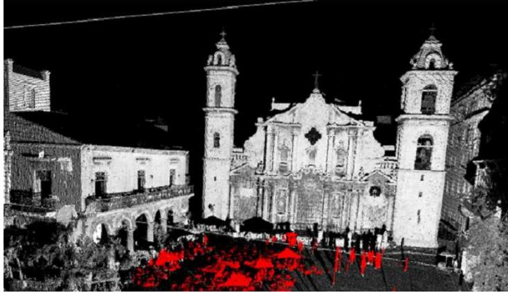
Figura 2.3.4. Nube de puntos con datos no deseados resaltados
